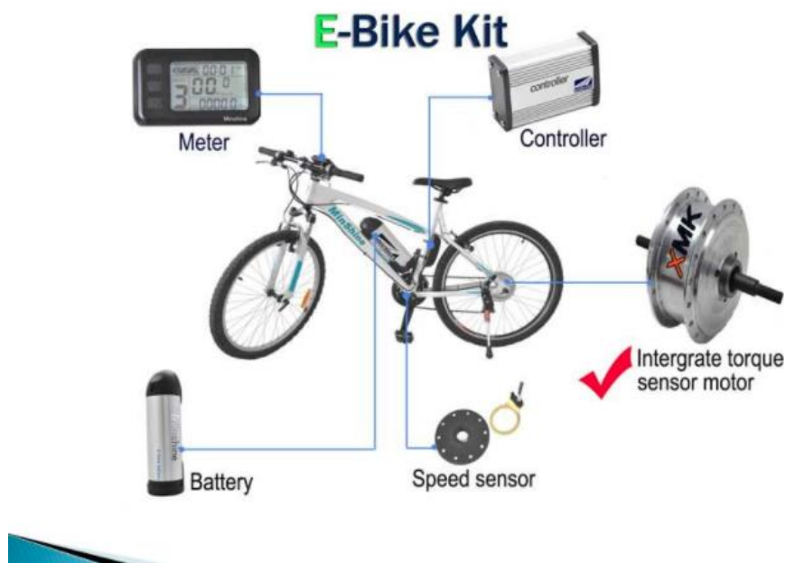
圖 1.1-4 電動輔助自行車技術架構 11
